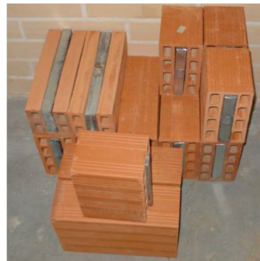
Глиняные кирпичи, содержащие макрокапсулы ФПМ
